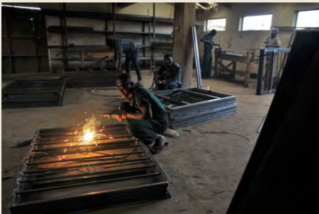
Herstellen von Metallfenstern in einem Ausbildungsbetrieb
